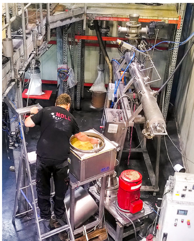
Hightech für das Leben: Mikronisierung und Fraktionierung des Pneumatit-Spezialmörtels in einer Industriemühle. (Bild ©Pneumatit)
